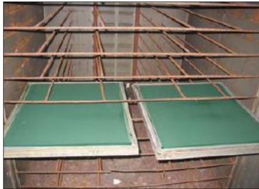
Resim 2.7:a) Şablon kurutma makinesi b) Kurutma dolabına şablonların yerleştirilmesi
