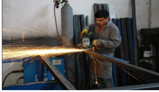
Resim 1.1: Spiral taşlama ile çerçeve üzerinde dişlerin açılması
